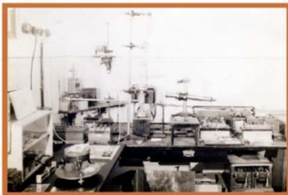
Опитната постановка, с която Г. Наджаков и Р. Андрейчин провеждат през 30-те години изследванията си върху контактнопотенциалния фотоволтаичен ефект
